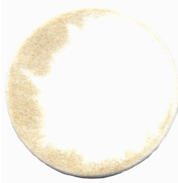
شکل شماره ۳: نشستی از فیلترها بر روی پد در اثر باردهی بیش از حد به فیلتر
