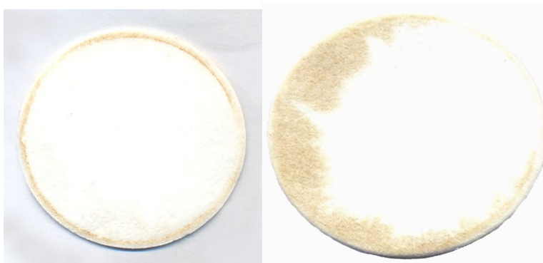
شکل فوق: نشتی از فیلتر ها بر روی پد در اثر باردهی بیش از حد به فیلتر
