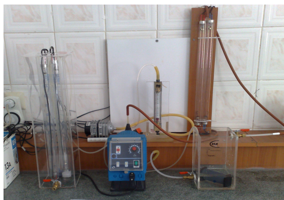
شکل ۱: رآکتور های مورد استفاده در این تحقیق، رآکتور لوله ای (سمت راست) و رآکتور ناپیوسته (سمت چپ)
